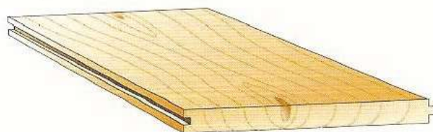
▲ Perfil de uma tábua com encaixe macho-fêmea característica.
